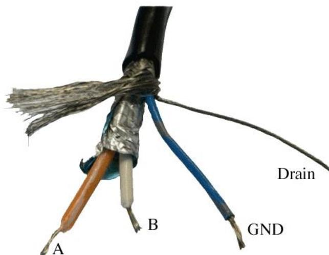
На рисунке изображен промышленный кабель Belden3106A для прокладки сетей RS-485. Данный кабель имеет волновое сопротивление 120 Ом и двойной экран витой пары. Кабель Belden3106A содержит 4 провода. Оранжевый и белый провод представляют собой симметричную экранированную витую пару. Синий провод кабеля используется для соединения нулевого потенциала источников питания приборов в сети и называется "общий" (GND)\*. Провод без изоляции используется для заземления оплетки кабеля и называется
