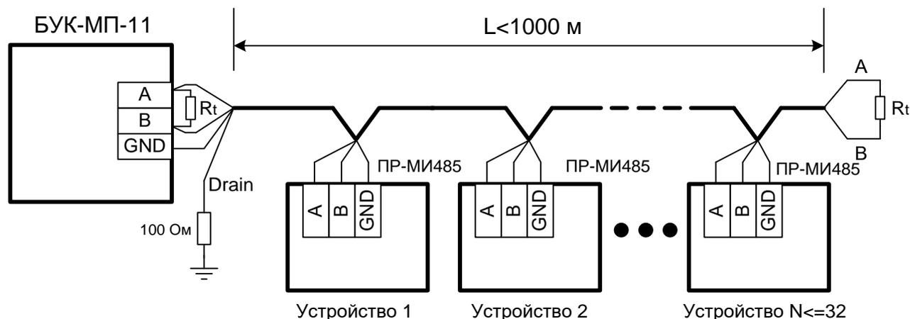
Сеть RS-485 строится по последовательной схеме, т.е. приборы в сети соединяются последовательно симметричными кабелями. Концы линий связи при этом должны быть нагружены согласующими резисторами - "терминаторами" ( $R_t$ ), величина которых должна быть равна волновому сопротивлению кабеля связи.
