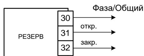
При заказе необходимо указывать тип выходов на исполнительные механизмы (МЭО, ПБР, Частотный преобразователь). По умолчанию все выходы - симисторные, для управления МЭО.
